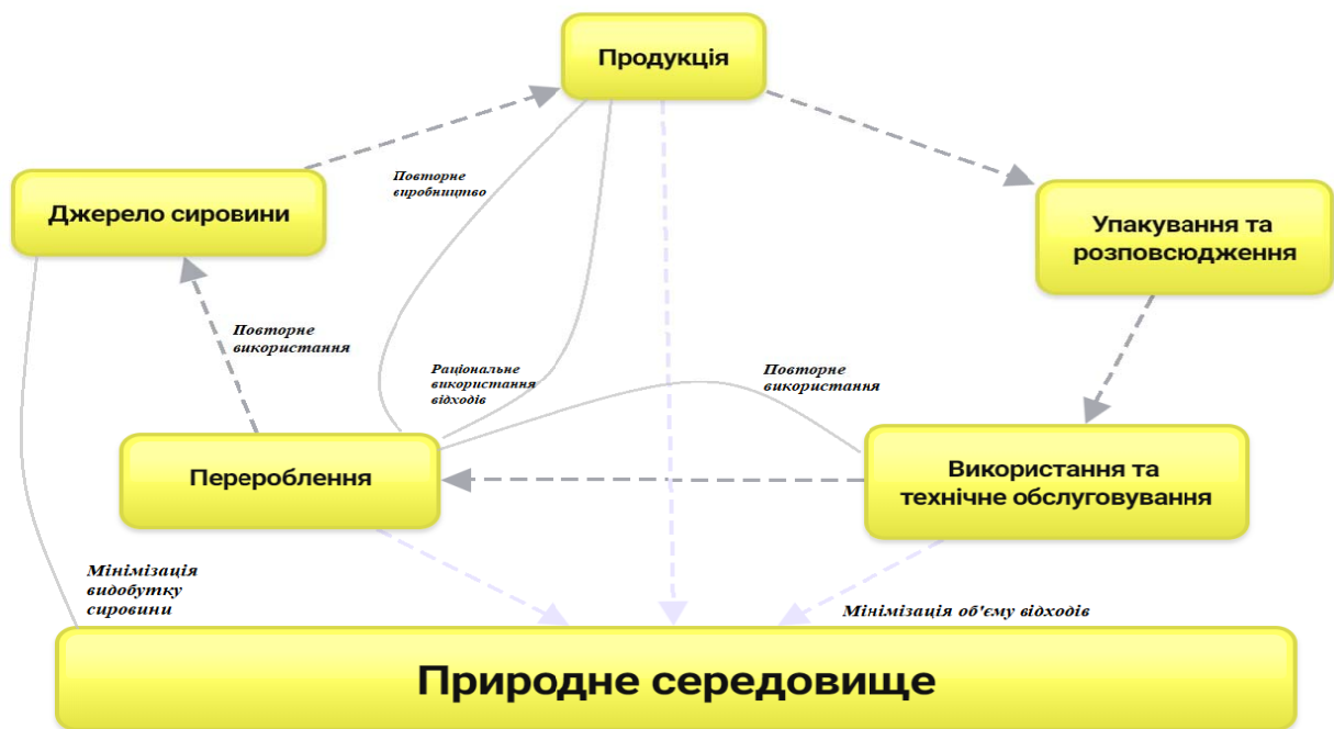
Рис.2. Замкнутий цикл виробництва в еко-індустріальних парках
